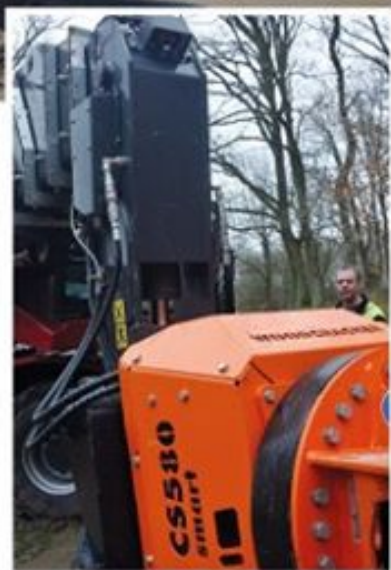
Großes Bild: Die Scherenabstützungen sind selbstnivellierend. Der Fällkopf wird mit einer Kamera überwacht. Das erleichtert das Positionieren des Kopfes.
