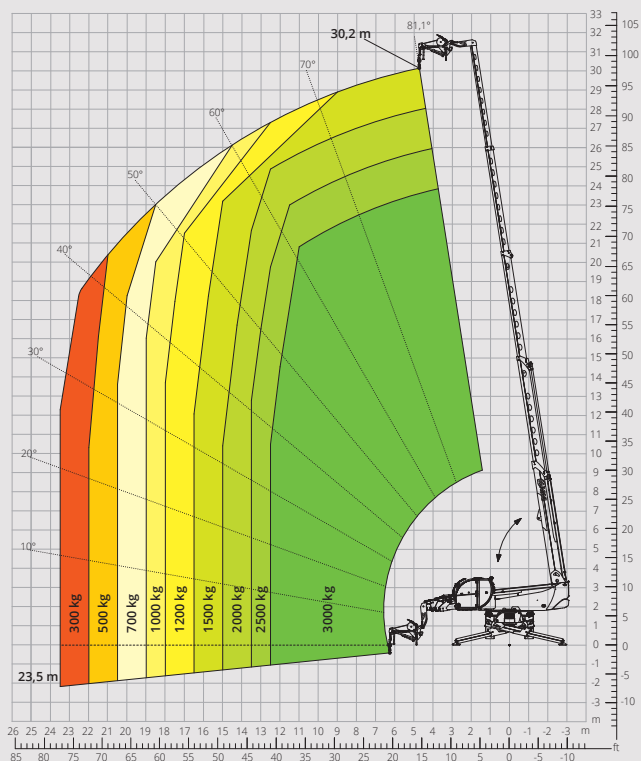
Diagramma portate con BRACCETTO TRALICCIATO CON ARGANO 3.000 kg ATT - 04 - 019
