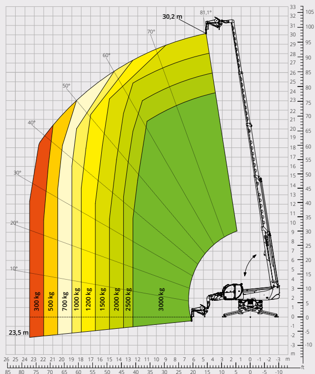
Abaque de charge avec POTENCE AVEC TREUIL 3 000 kg ATT - 04 - 019
