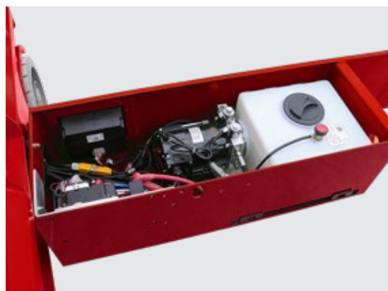
Système de pompage à haute efficacité
