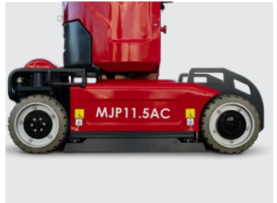
Sistema automático de protección de baches
